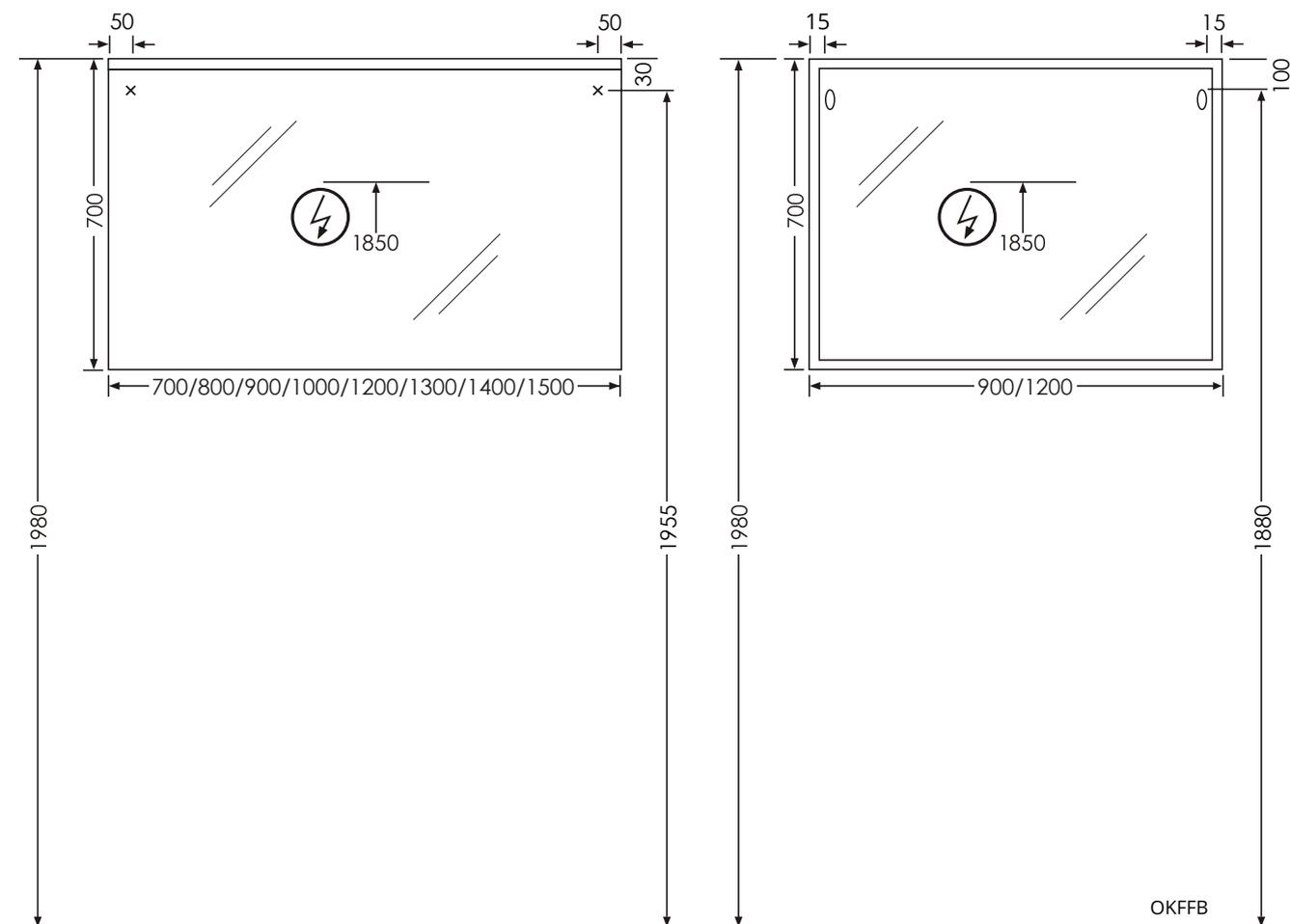
OKFFB = Oberkante Fertigfußboden | Alle Maßangaben in Millimeter | Höhenangaben sind empfohlen und müssen nicht eingehalten werden!
