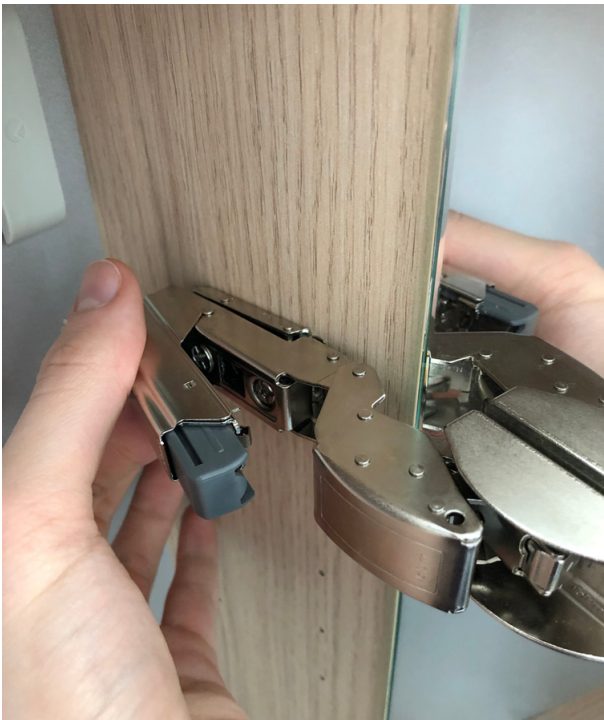
Abb. 4 | Montage von Glastürdämpfung und Abdeckkappe
