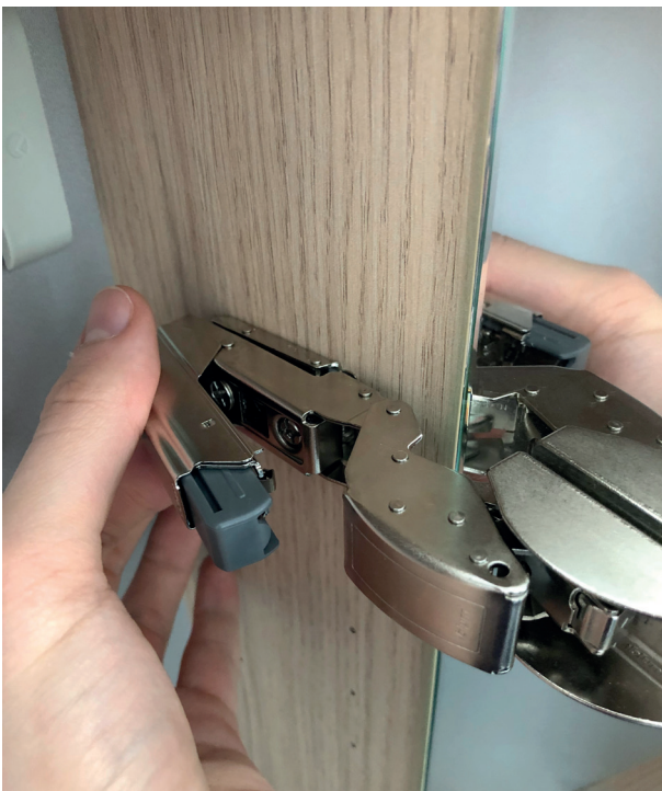
Abb. 4 | Montage von Glastürdämpfung und Abdeckkappe
