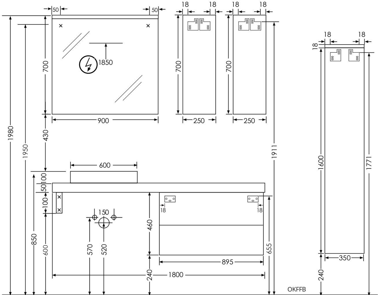
OKFFB = Oberkante Fertigfußboden | Alle Maßangaben in Millimeter | Höhenangaben sind empfohlen und müssen nicht eingehalten werden!
